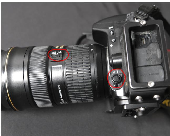
Sur l'objectif, positionner le commutateur sur **M** manuel
